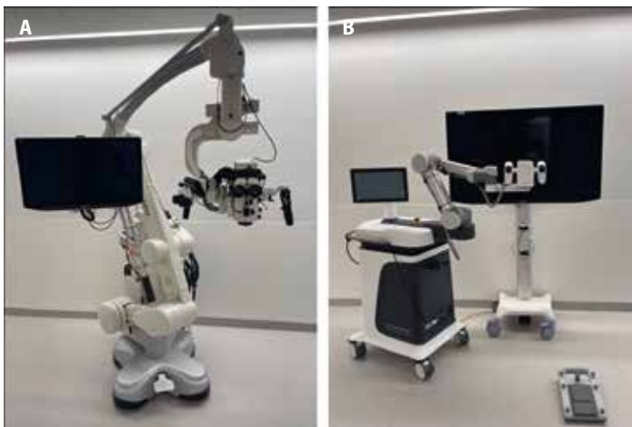
KUVA 1. Leikkausmikroskooppi ja optinen kamera. A. Mikroskoopissa kirurgin okulaarien alle on sijoitettu suuhjaukappale, ja vieressä sijaitsevat myös avustavan kirurgin okulaarit. Optinen kamerayksikkö kiinnittyy tasapainotetun ja nivelletyn kameravarren päähän. B. Eksoskoopissa digitaalinen kamerayksikkö sijaitsee motorisoidun kameravarren päässä. Erillinen ja jalustalla liikuteltava näyttö on sijoitettu kuvassa eksoskoopin taustalle. Ohjaamiseen käytettävissä oleva jalkapoljin on asetettu lattialle.
