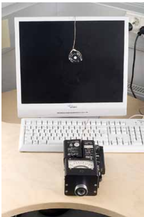
KUVA 1. A) Näytön suorituskyvyn mittaaminen teleskooppisella valomittarilla. Mittariin on liitetty suojaputki ympäröivän valon vaikutuksen ehkäisemiseksi. B) Kuvankatselutilan valaistusvoimakkuuden määrittäminen valomittarilla. Näytön keskiosassa olevan mittarin anturi osoittaa kuvankatselutilaa kohti.
