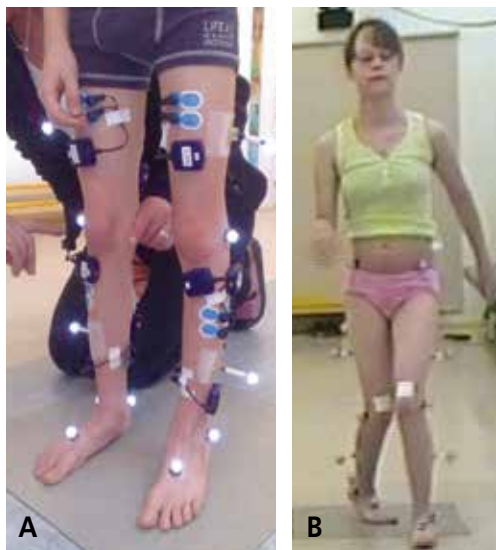
KUVA 1. Heijastavien merkkien (valkoiset) asettelu alaraajoihin (A). Kuvassa myös EMG-pinta-elektrodit (sinivalkoiset) vahvistimineen nilkan koukistajien ja polven ojentajien asettelussa. Mittaustilanteessa kävely (B).
