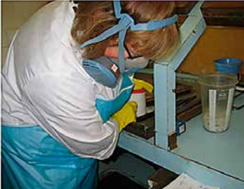
KUVA 1. Professori Dammertin 80-luvulla teettämä vetokaappi, joka vaati formaliinisudattimen käyttöä.
