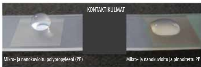
Vesipisara pinnoilla erittäin huonosti kastuva PP-pinta vasemmalla, Coldab™-pinnoitettu hyvin kastuva pinta oikealla (Picodeon Ltd)
